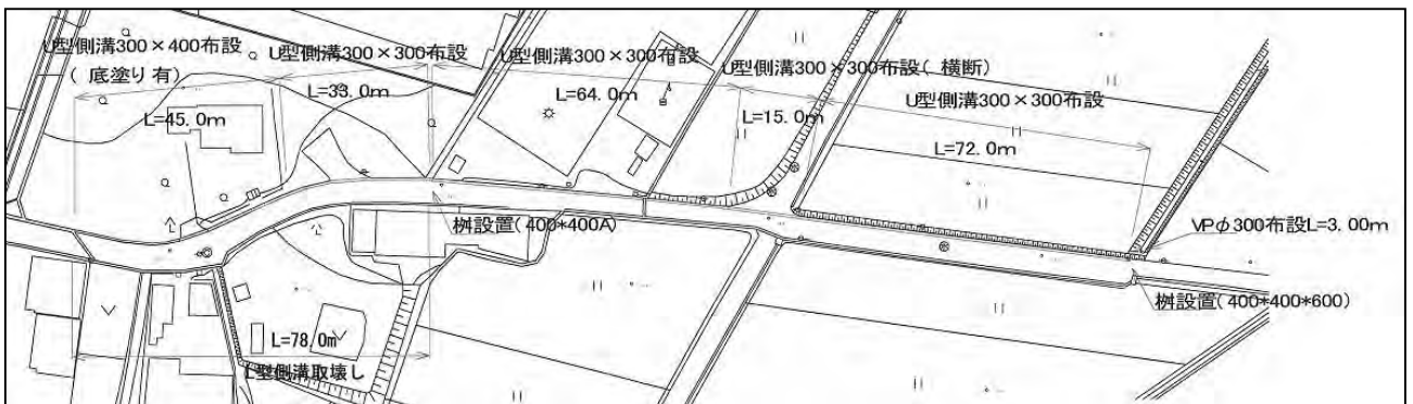
側溝補修工事の概略設計図(JW-CADで編集)
